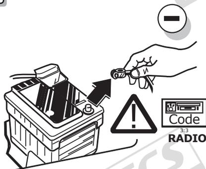
**DE** Um Störungen und Schäden am Bordnetz zu vermeiden, muss die Massepolklemme unbedingt vor Beginn aller Arbeiten von der Fahrzeugbatterie getrennt werden! Insbesondere bei Arbeiten und Anschlüssen am CAN-Datenbus kann bei nicht abgeklemmter Batterie sowohl das Anhängermodul als auch das fahrzeugseitige Bordnetzsteuergerät beschädigt werden! Bitte Herstellervorschriften beim Ab- und Anklemmen der Fahrzeugbatterie beachten!
