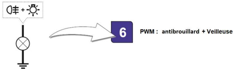
Dans ce cas de figure il faut brancher les fils du faisceau comme ci-dessous :
