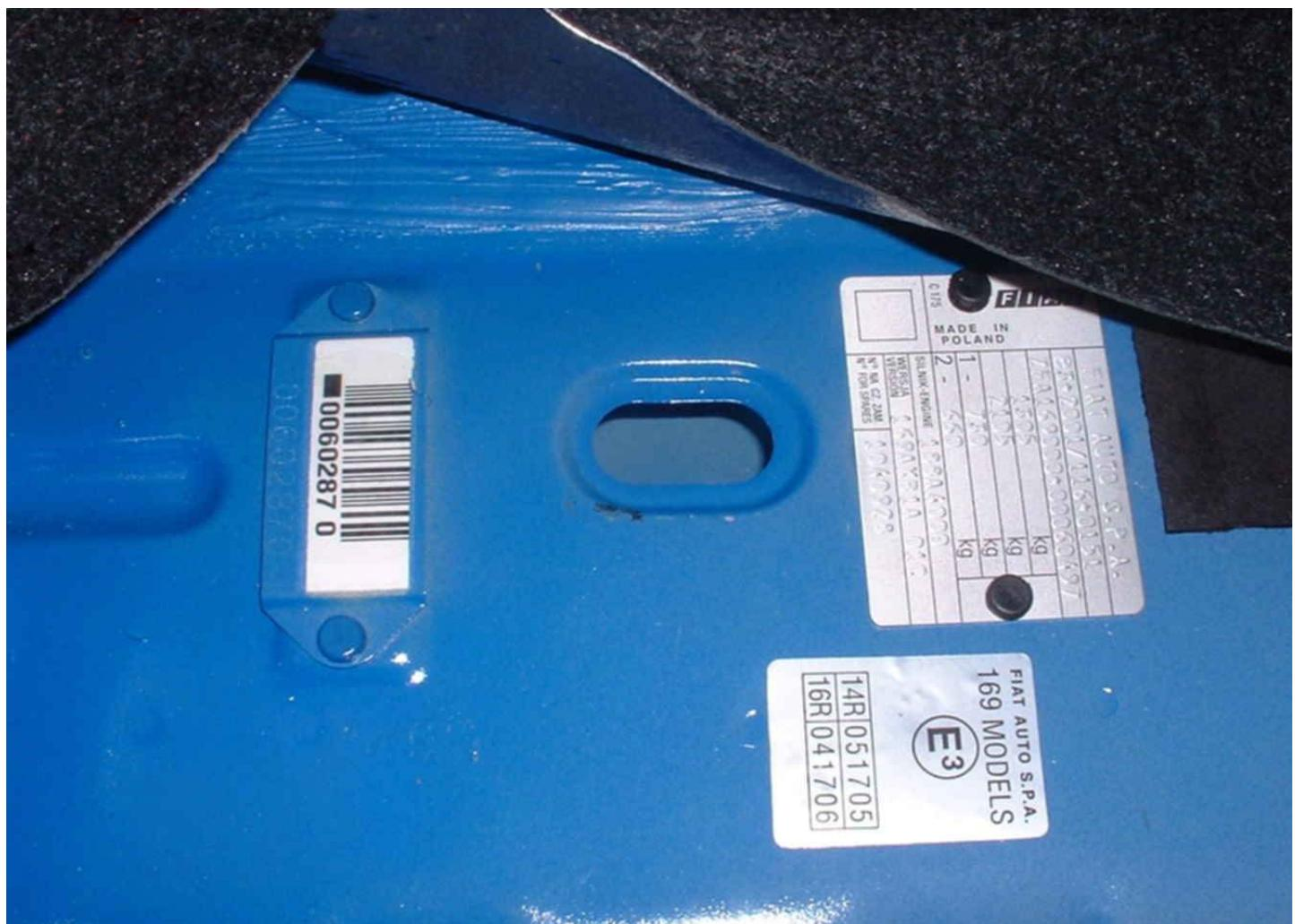
**Foto 2 : voorziene opening rechts in kofferruimte voor moerstuk (5)**
