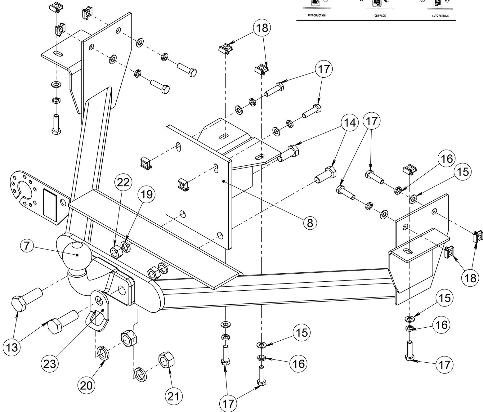
Après avoir éliminé les surépaisseurs de mastic, introduire dans leur logements les écrous cages en repérant si nécessaire avec la ferrure leur position (voir croquis).
